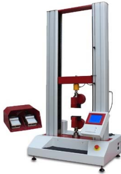
Рис. 1. Машина для испытания на растяжение
