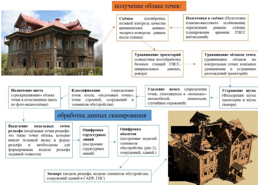
Рис. 1. Процесс получения 3Д-модели здания применяя метод 3Д сканирования
