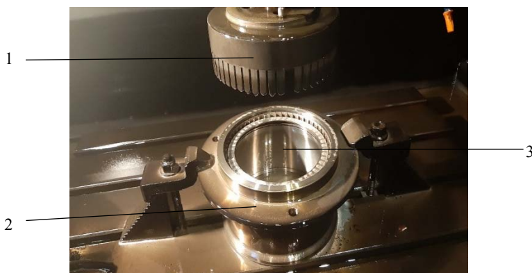
Рис. 2. Приспособление для закрепления детали «Цилиндр блока камеры»: 1) электрод-инструмент; 2) приспособление; 3) деталь «Цилиндр блока камеры».
