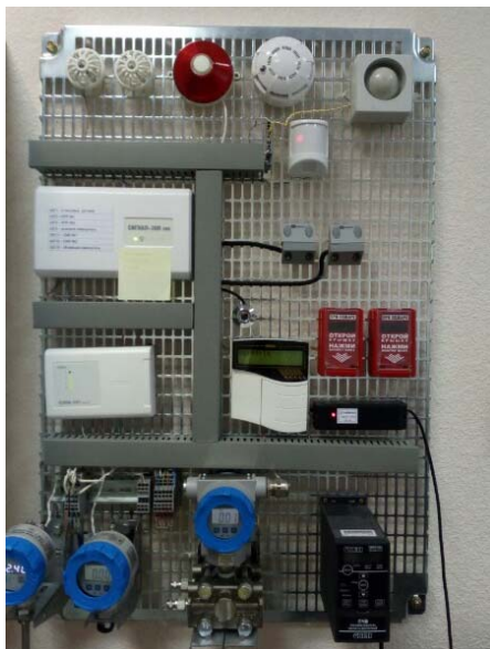
Рис.1. Имитационный охранно-пожарный стенд
