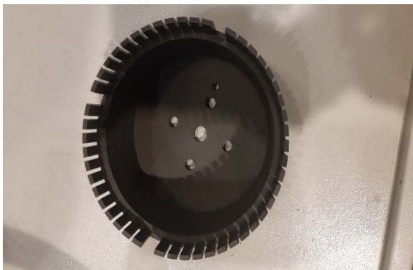
Рис. 1. Электрод-инструмент для обработки пазов-каналов
