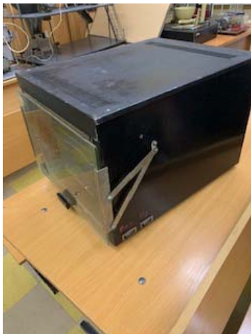
Рис. 1. Общий вид аппарата для обжарки гречишного солода инфракрасным излучением.
