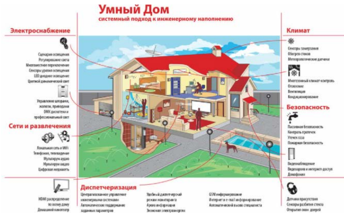
Рис. 2. Инженерное наполнение умного дома
