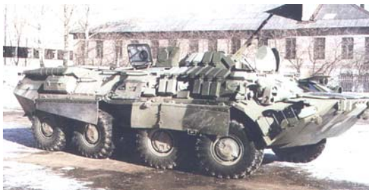
Рис. 2. Бронетранспортёр с блоками дополнительной пассивной защиты
