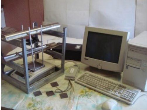
Рис. 1. Экспериментальный аппарат для исследования процесса инфракрасной сушки скорлупы грецких орехов
