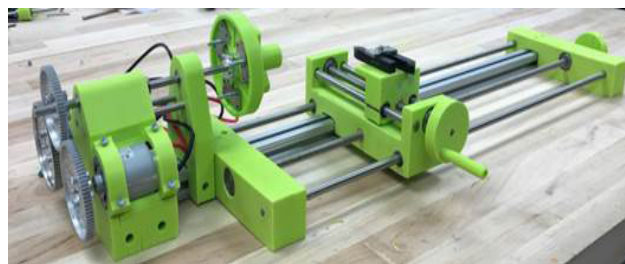
Рис. 2. Токарный станок с элементами, распечатанными на 3D принтере
