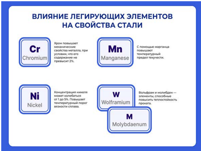
Рис. 3. Влияние легирующих элементов на свойства стали
