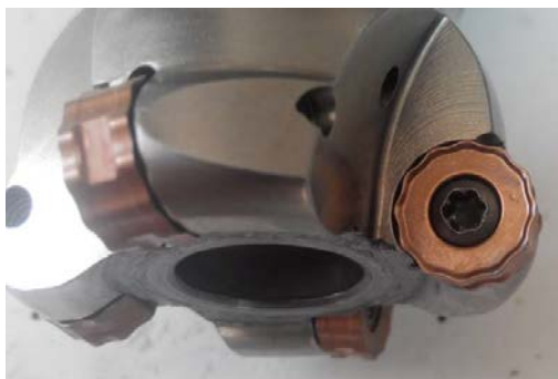
Рис. 3. Фотография инструмента после обработки по стратегии «растр»
