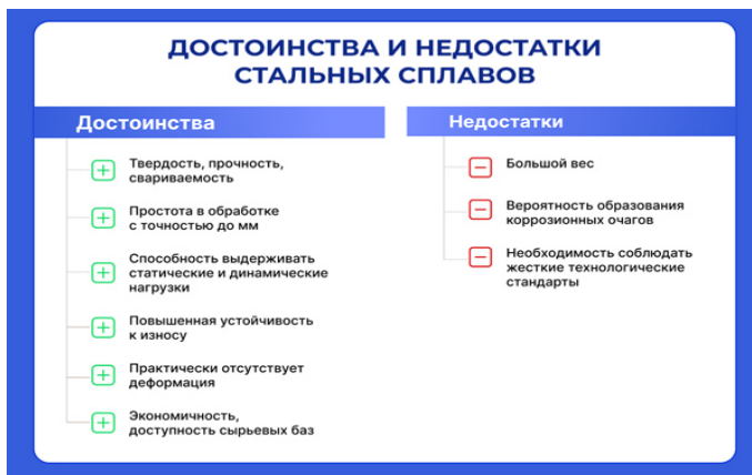
Рис. 2. Достоинства и недостатки стальных сплавов [4]
