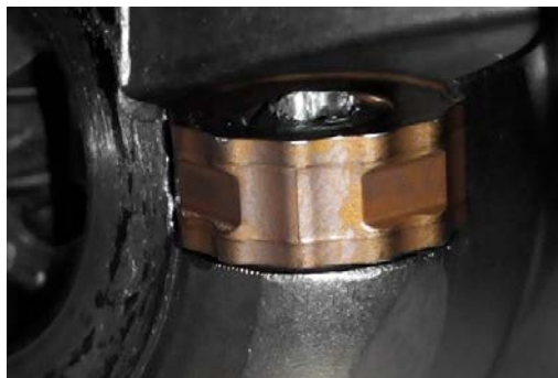
Рис. 6. Фотография инструмента после обработки по стратегии «постоянная Z»
