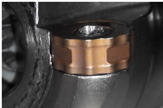
Рис. 4. Фотография инструмента после обработки по стратегии «растр»
