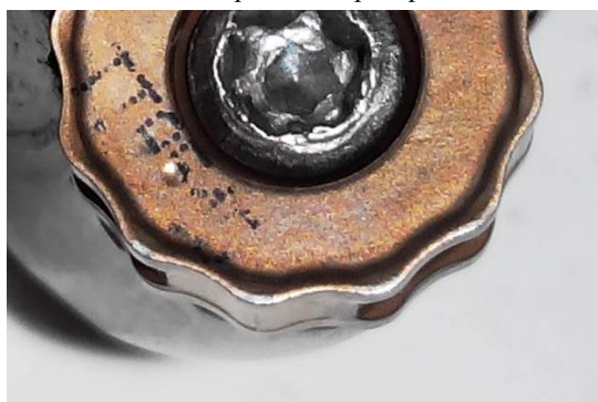
Рис. 5. Фотография инструмента после обработки по стратегии «постоянная Z»
