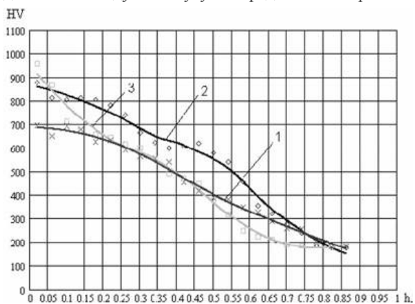
Рис. 5. Распределение твердости HV по толщине упрочненного слоя на трех режимах:
