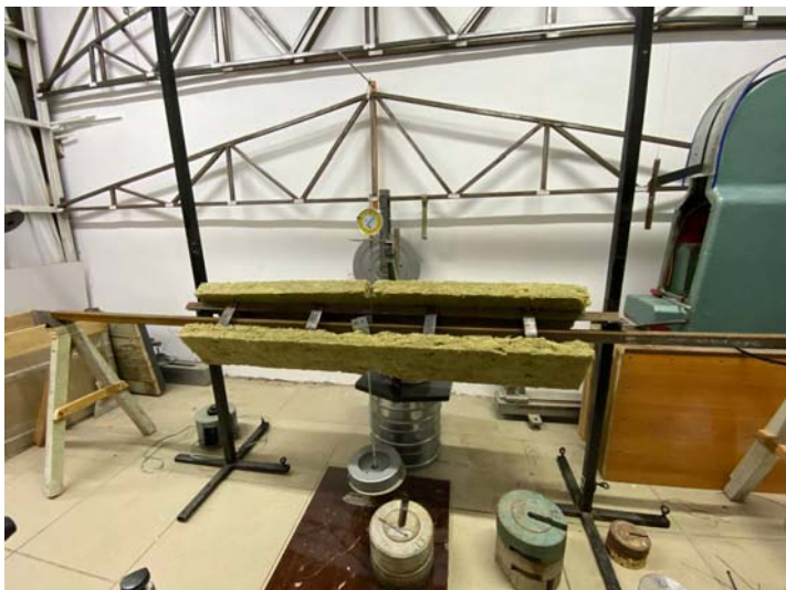
Рис. 1. Установка для проведения измерений прогиба
