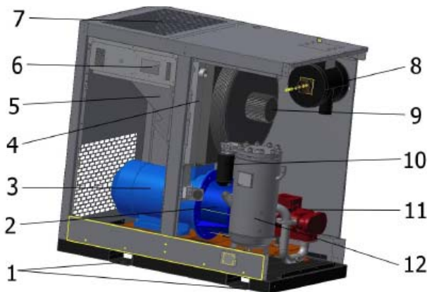
Рис.1. Состав установки: 1 – отверстия под захваты вилочного погрузчика; 2 – проставка муфты; 3 – электродвигатель приводной; 4 – блок охлаждения; 5 – короб направляющий; 6 – панель управления; 7 – сетка выхода воздуха; 8 – воздухоочиститель; 9 – электрический вентилятор; 10 – фильтр масляный; 11 – компрессор; 12 – сепаратор
