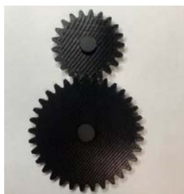
Рис.1 Макет эвольвентной зубчатой передачи
