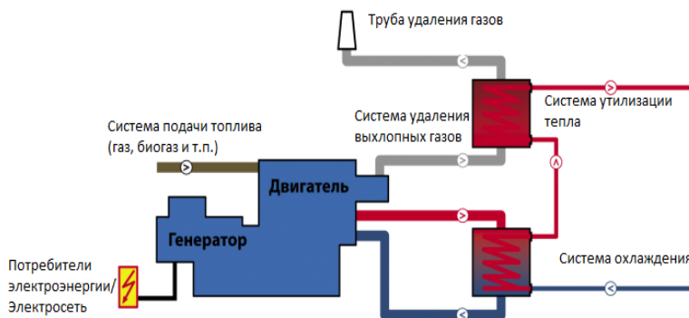
Рис.2. Общая схема устройства газопоршневой электроустановки
