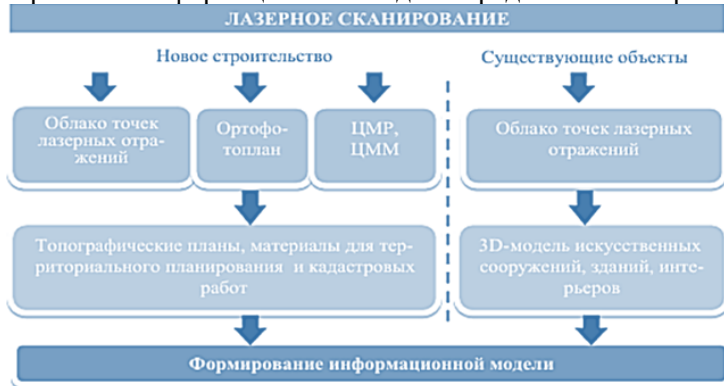
Рис. 1. Схема формирования информационной модели
