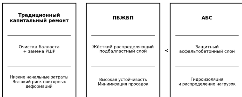
Рис. 1. Обобщенная схема сравнения технологий капитального ремонта пути
