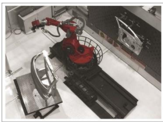
Рис. 4. Установка для автоматизированного контроля качества на основе фотограмметрической системы
